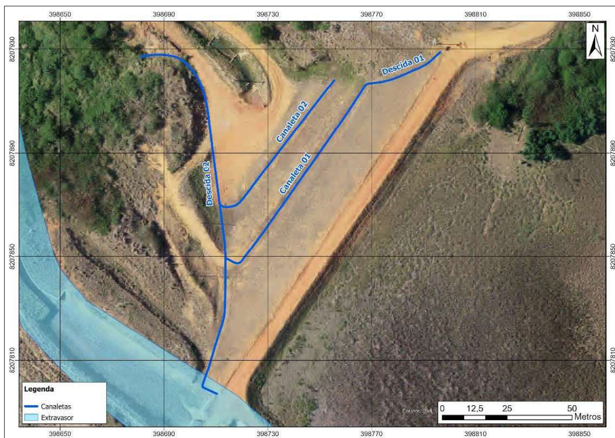
Figura 6.8 - Sistema de drenagem superficial da Barragem Califórnia
